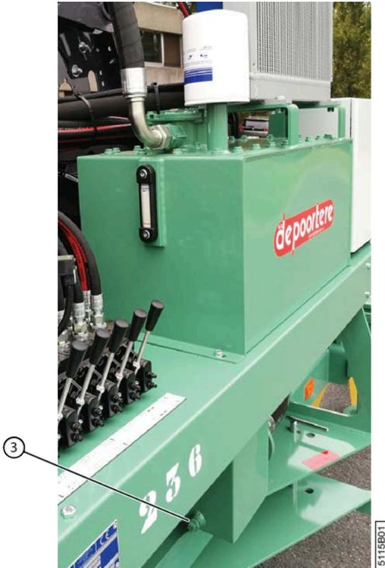
Fig. 142: Vidanger le réservoir hydraulique
