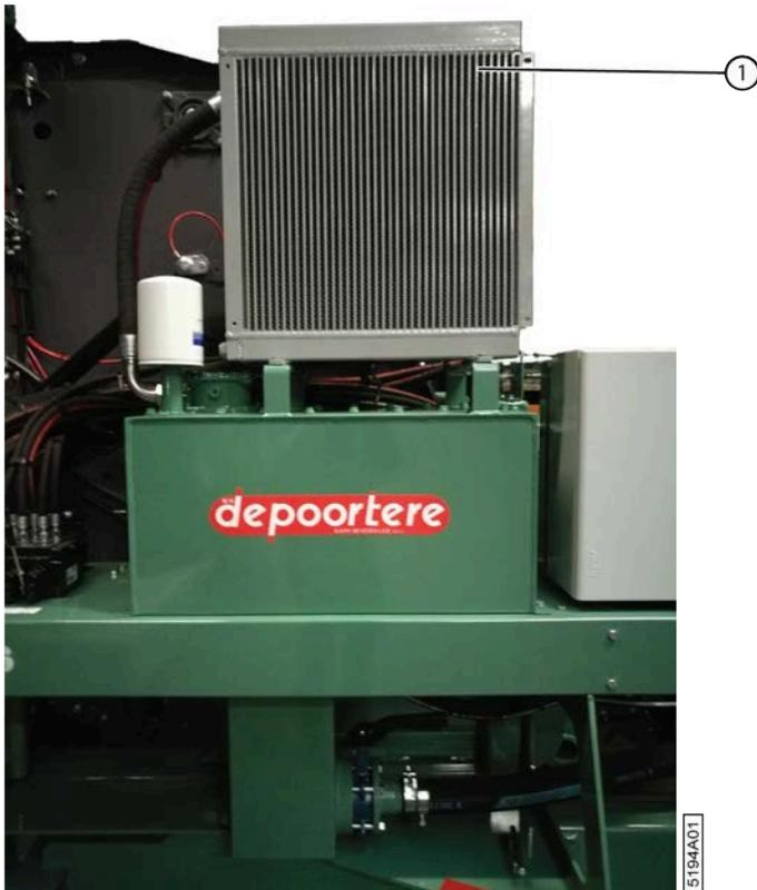
Fig. 101: Nettoyer le radiateur de l'huile hydraulique
