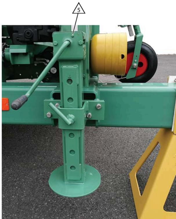
Fig. 118: Lubrifier la béquille mécanique
