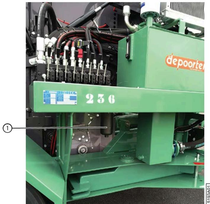
Fig. 100: Remplacer le filtre haute pression
