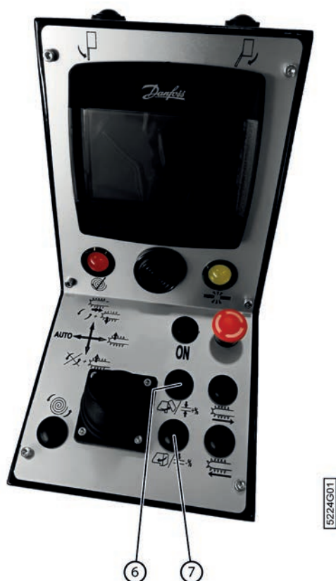
Fig. 74: Régler l'épaisseur de la nappe de lin avec la console de commande
