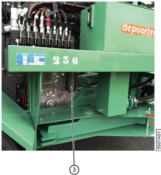
Fig. 145: Filtre haute pression
