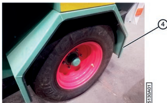
Fig. 34: Détail de la protection du bord du garde-boue
