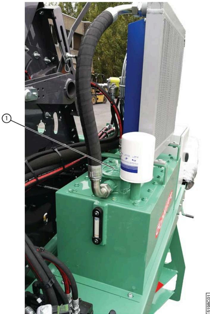
Fig. 110: Filtre de retour réservoir hydraulique
