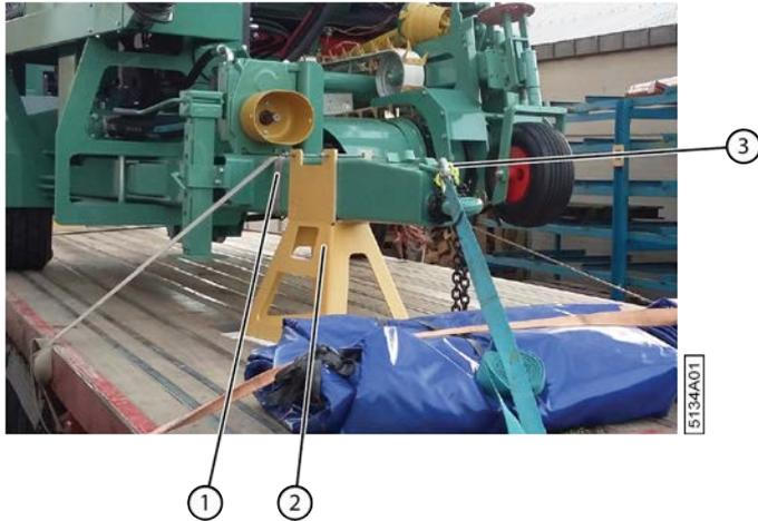
Fig. 41: Fixer la machine sur le camion (avant)
