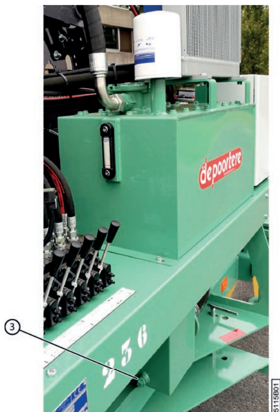
Fig. 142: Vidanger le réservoir hydraulique
