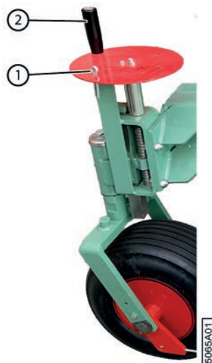
Fig. 80: Régler la hauteur du pick-up
