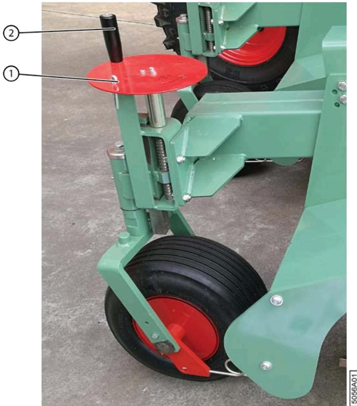
Fig. 80: Régler la hauteur du pick-up
