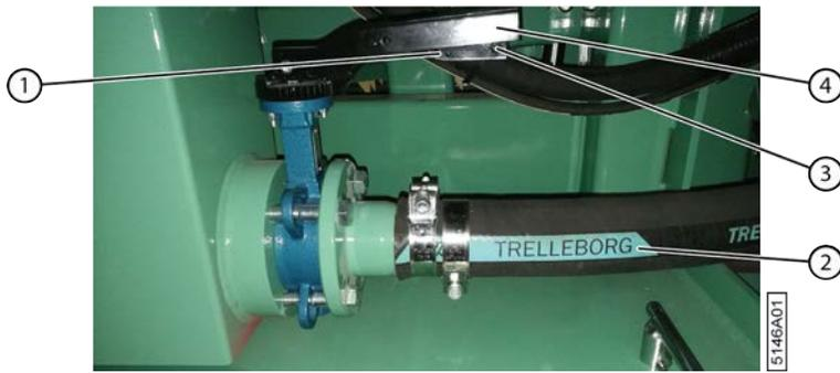
Fig. 55: Vanne manuelle hydraulique
