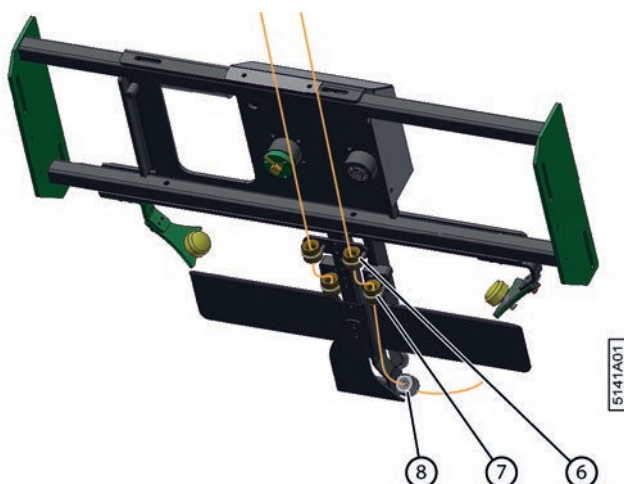
Fig. 50: Faire passer la ficelle dans le système de liage par ficelle
