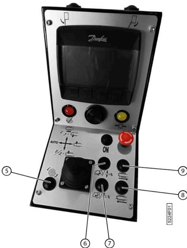
Fig. 72: Vérifier le fonctionnement des boutons de la console de commande
