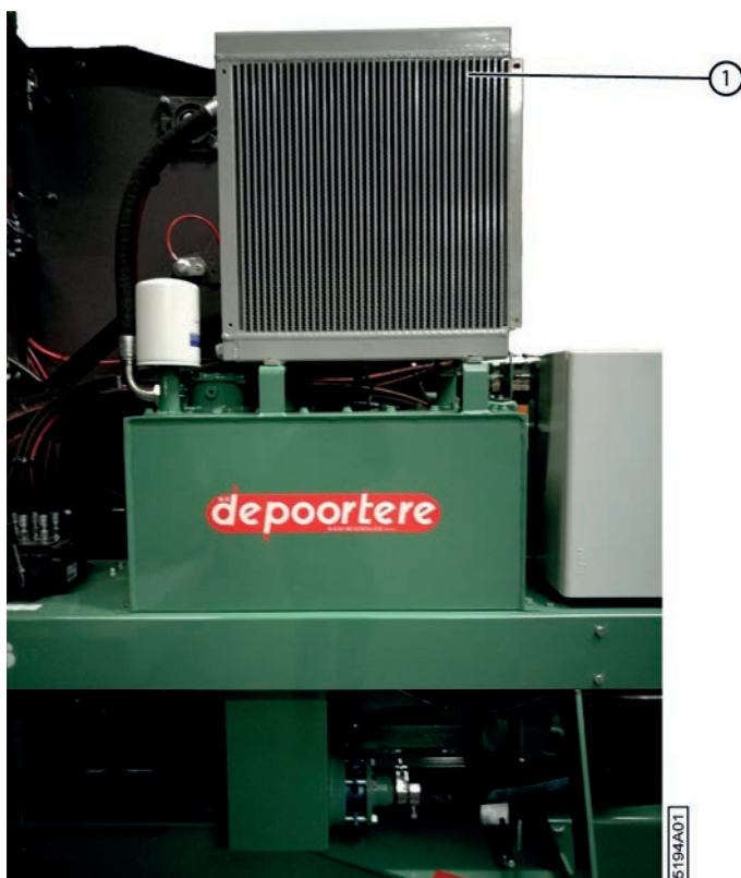
Fig. 101: Nettoyer le radiateur de l'huile hydraulique
