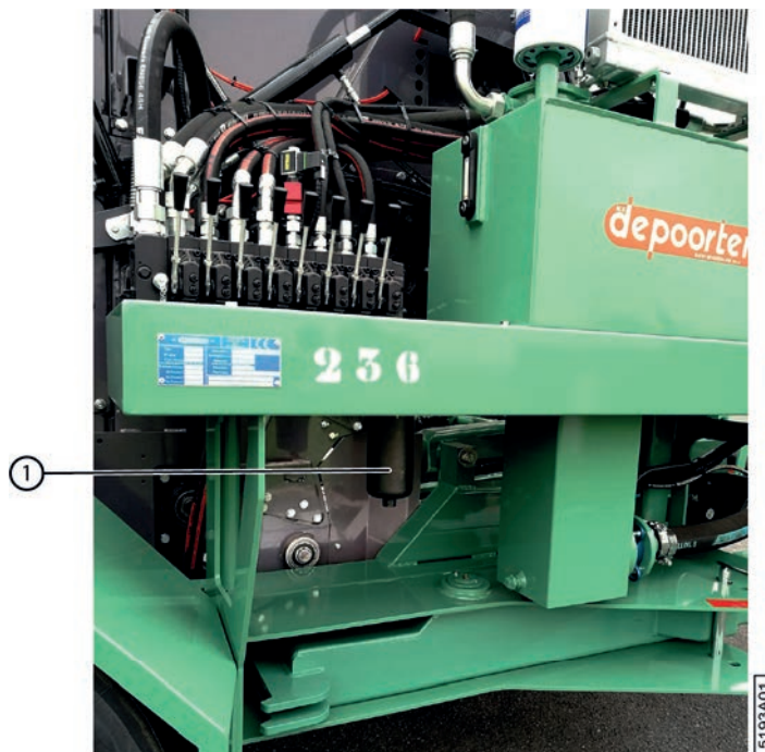
Fig. 100: Remplacer le filtre haute pression
