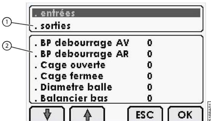
Fig. 64: Sélectionner un élément dans le sous-menu
