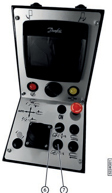
Fig. 73: Ouvrir et/ou fermer la cage avec la console de commande
