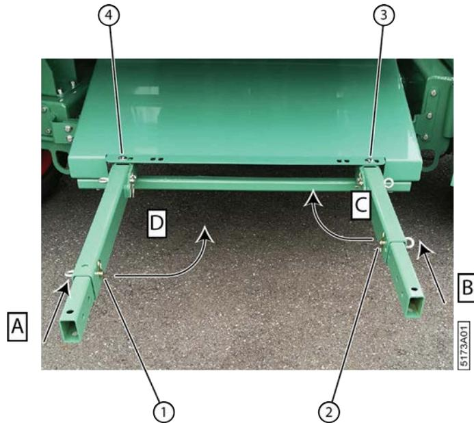
Fig. 78: Replier les barres d'éjection de balle
