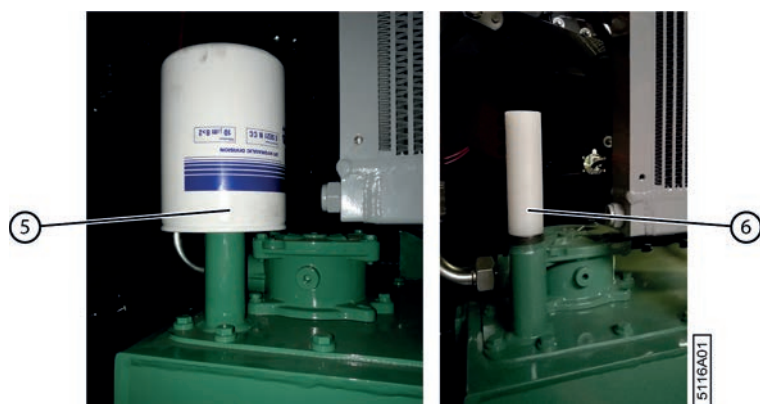
Fig. 16: Purgeur et dispositif anti-déversement
