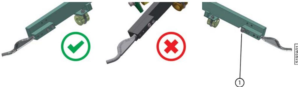
Fig. 137: Vérifier l'emplacement du bloc du doigt
