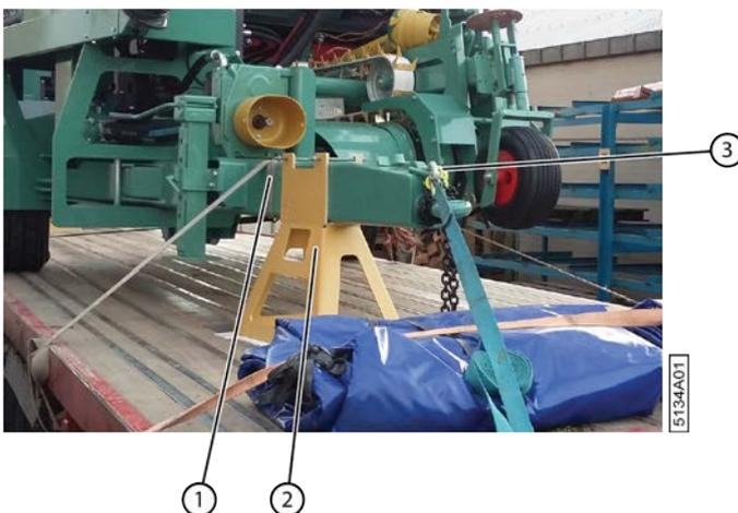
Fig. 44: Fixer la machine sur le camion (avant)
