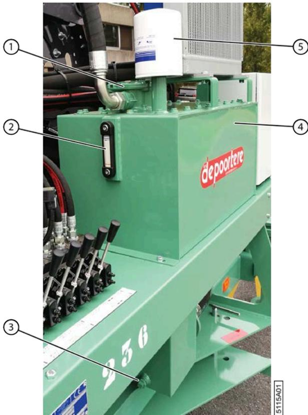
Fig. 15: Réservoir hydraulique
